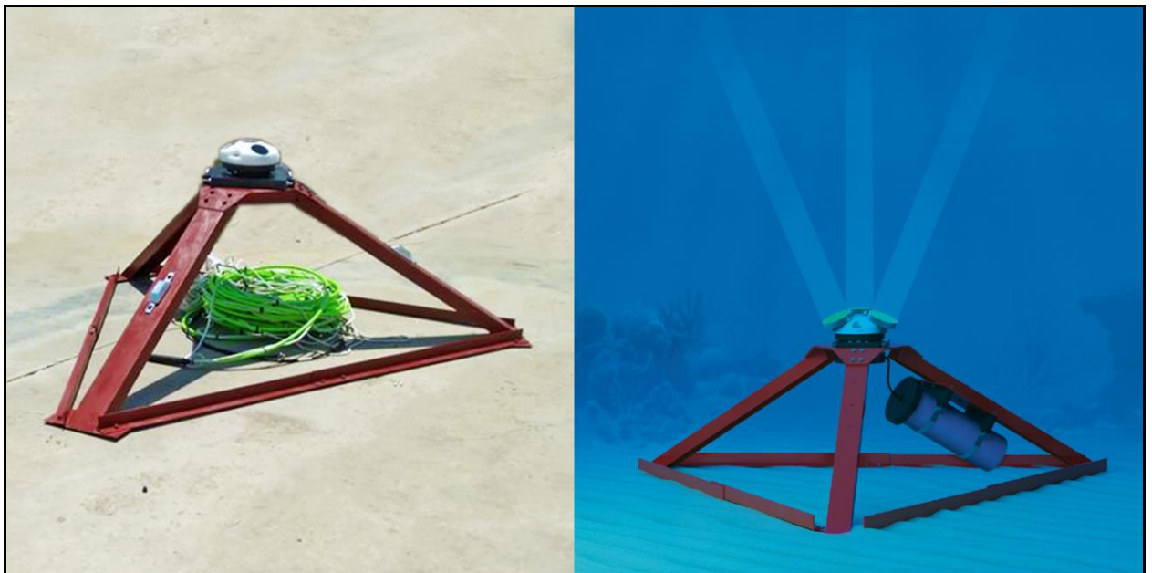
Σχήμα3: Το υποσύστημα Πυθμένα του Σταθμού Παρατηρήσεων (πυραμοειδής βάση, αισθητήρες Πυθμένα, εξοπλισμός και καλώδιο επικοινωνίας.)
